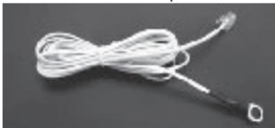
ProNauticP è dotato di serie di una sonda di temperatura di tipo plug&play. La sonda di temperatura deve essere collegata mentre il caricabatteria è spento o prima che sia collegato al sezionatore durante l'installazione. Per ottenere le migliori prestazioni, collegare la sonda al terminale negativo della batteria/banco "pozzetto".
